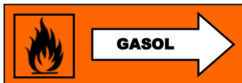
Rörledningsmärkning med farosymbol
